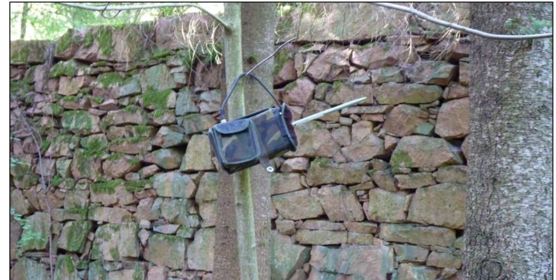
Figure 19 : Modules « BC box » du Batcorder installés sur un mât de mesure
