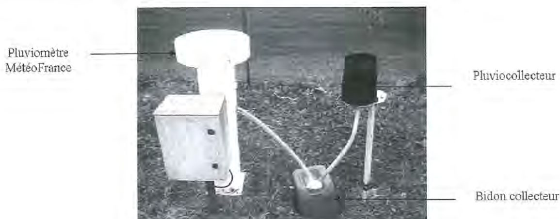
Figure I-20 : Dispositif d'échantillonnage des précipitations à la station météorologique de Sayat.
