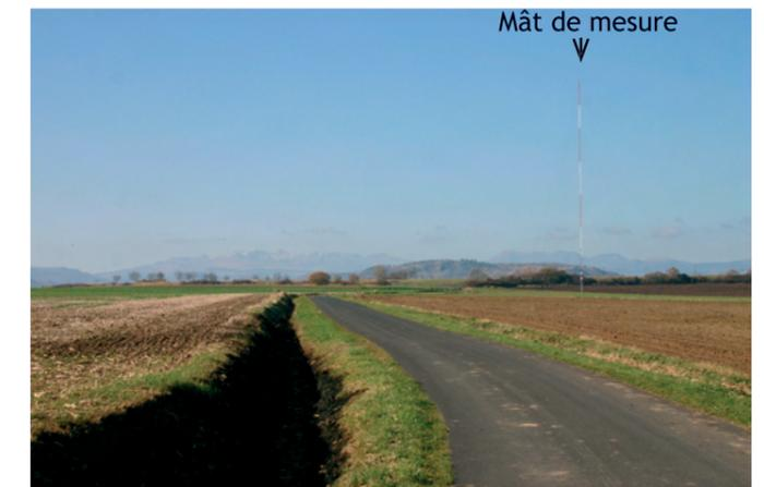
Fig.22. Mât de mesure du vent sur le site éolien
