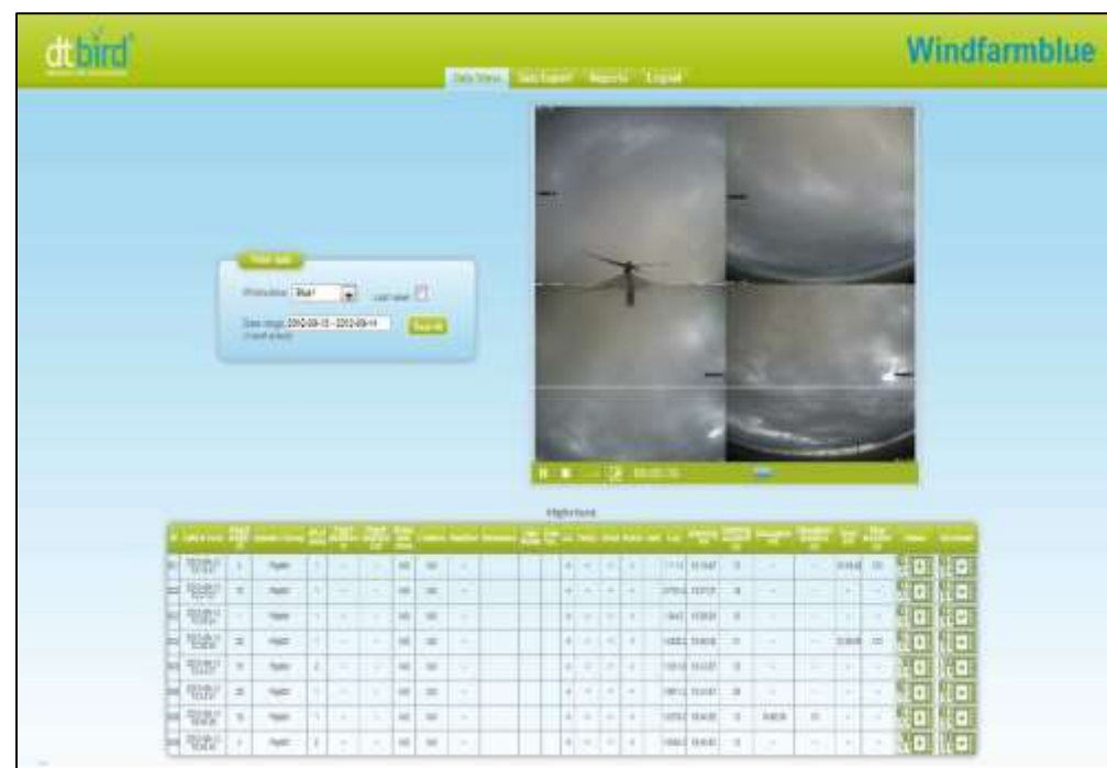
Figure 55: Exemple d'une page internet d'un module de suivi vidéo à distance en temps réel (dtbird)
