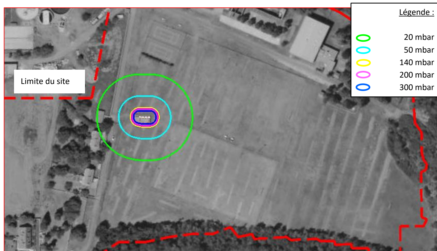
Figure 53 : Représentation graphique des distances d'effets de surpression – Chaudière
