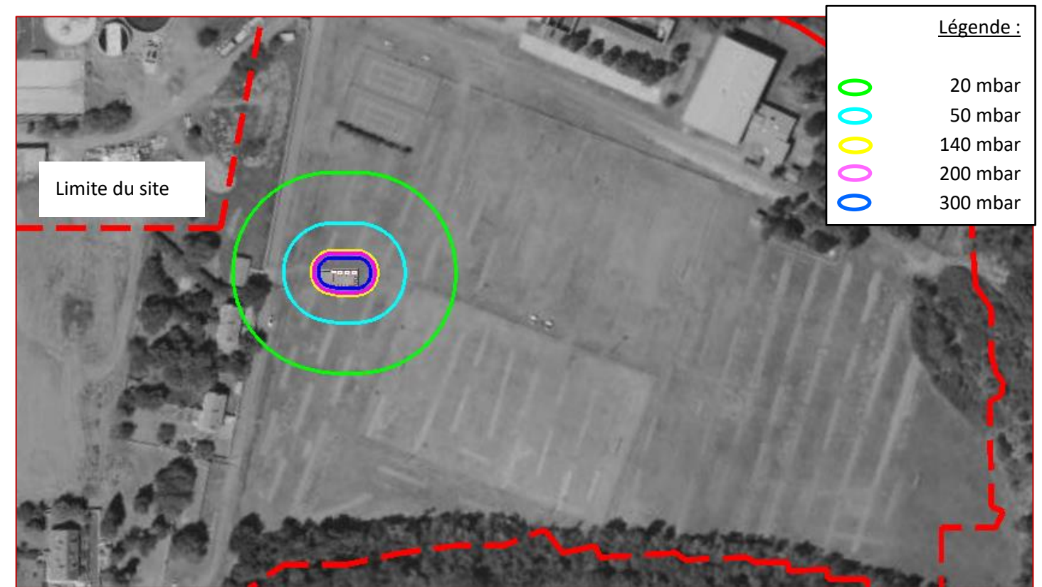
Figure 3 : Représentation graphique des distances d'effets de surpression – Chaudière
