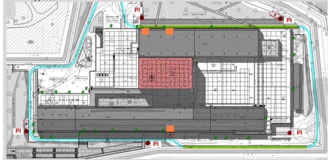
Des colonnes sèches seront prévues desservant la Serre depuis les voies engins et permettant d'acheminer de l'eau en partie centrale du bâtiment.
