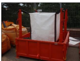
Décantation de l'eau de lavage des outils
