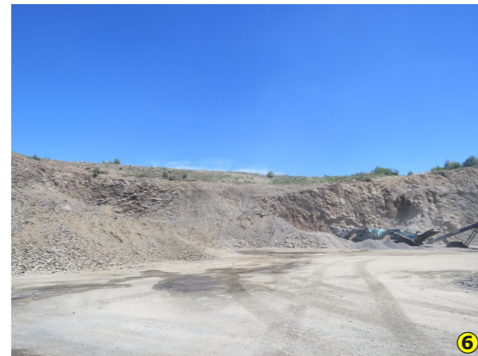
Stocks et groupe mobile de concassage-criblage
