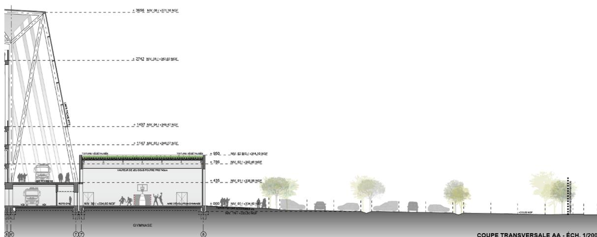
Figure 17 : Extrait de la coupe transversale Ouest-Est montrant la distance du bâtiment jusqu'à la limite d'intervention du projet d'extension
