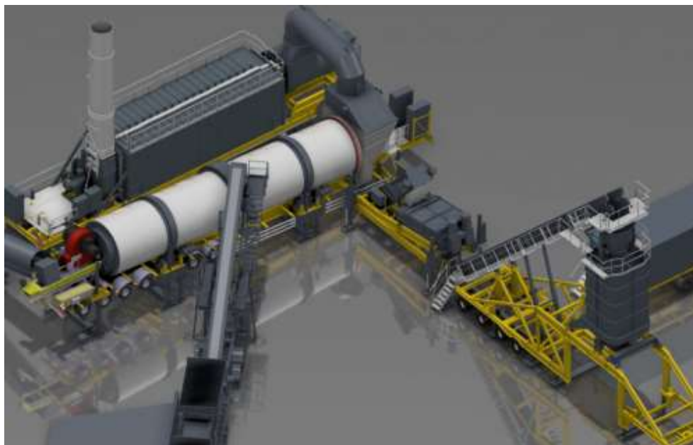
Illustration n° 3 : Centrale continue ERMONT de type TSX28
