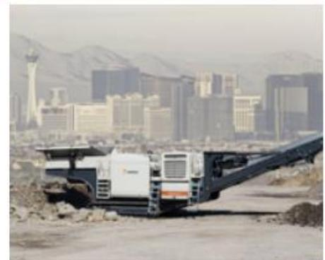
L'obtention d'un permis environnemental peut être un défi lors du traitement de la roche dans des zones densément peuplées. Pour vous aider à accéder à ces sites, nous avons développé l'installation de concassage Lokotrack® Urban™. La nouvelle solution permet de réduire jusqu'à 60% les distances de protection contre le bruit de 85 dB (A) et de réduire considérablement les émissions de poussières, permettant ainsi des opérations de concassage, le cas échéant.
