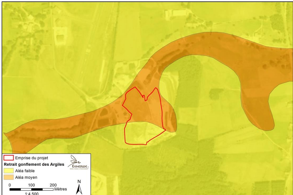
Figure 64 : Zones de retrait-gonflement des sols argileux (source GEORISQUES)
