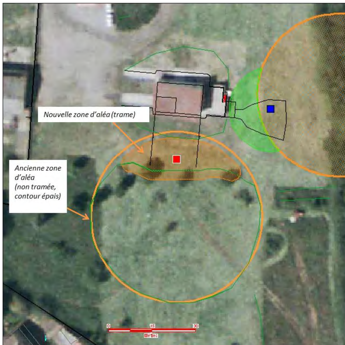
Figure 20 : Modification de l'aléa effondrement localisé moyen lié au puits issu de l'atlas Dorlhac
