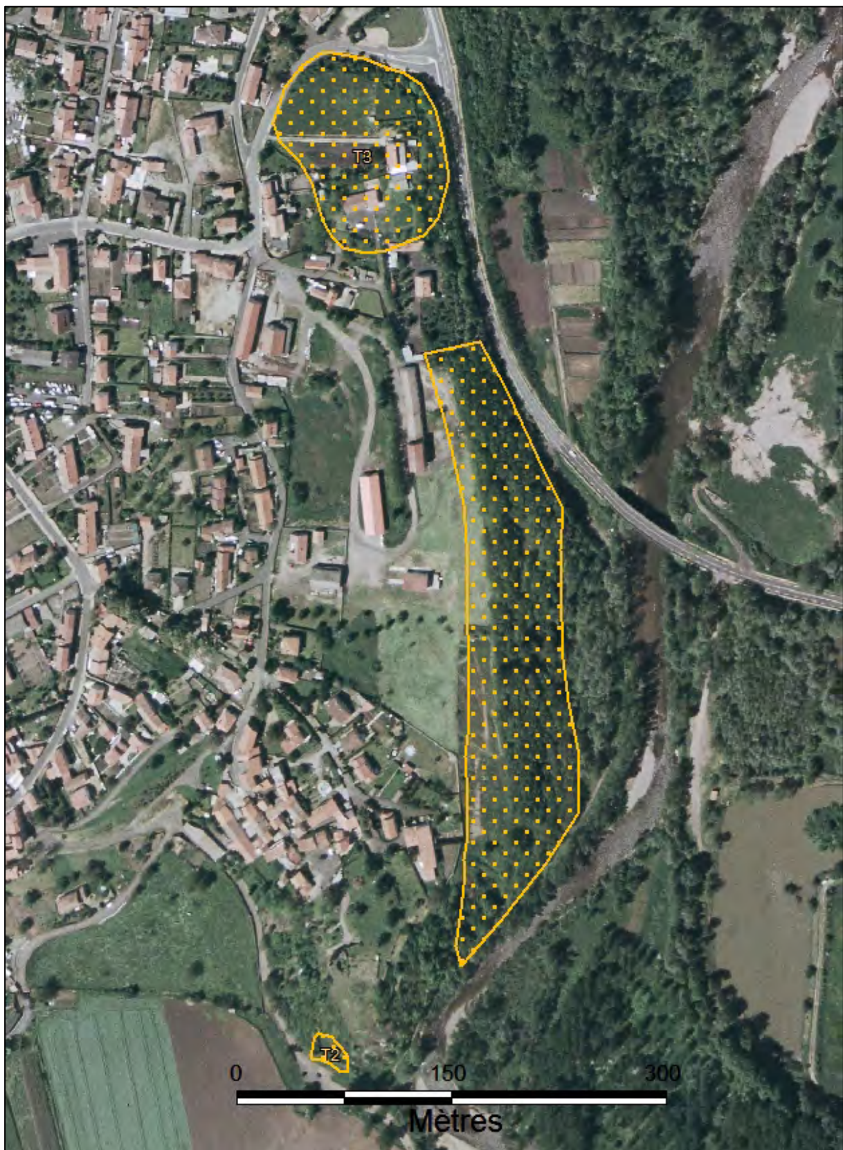
Figure 27 : Emprise du dépôt de bord de plateforme du puits Saint Alexandre après analyse des plans et observations de surface
