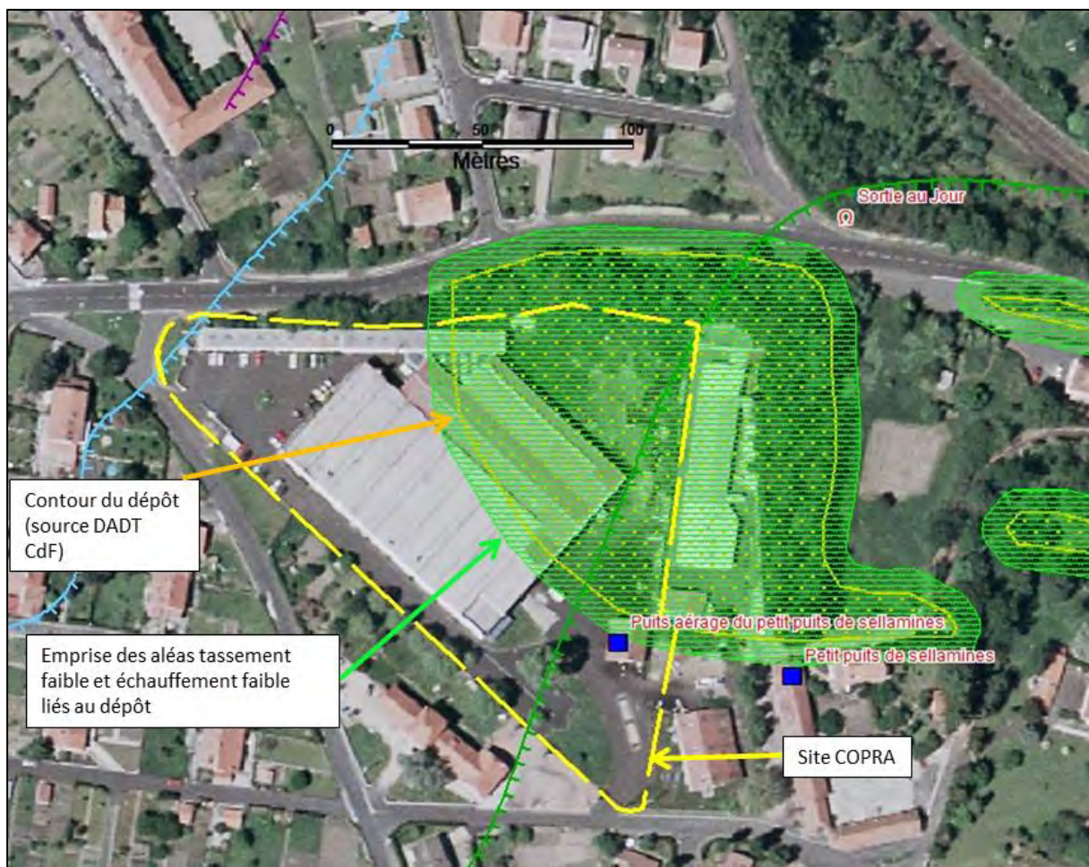
Figure 8 : Site COPRA - aléas tassement faible et échauffement faible en liaison avec la présence d'un ancien dépôt
