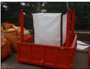
Décantation de l'eau de lavage des outils
