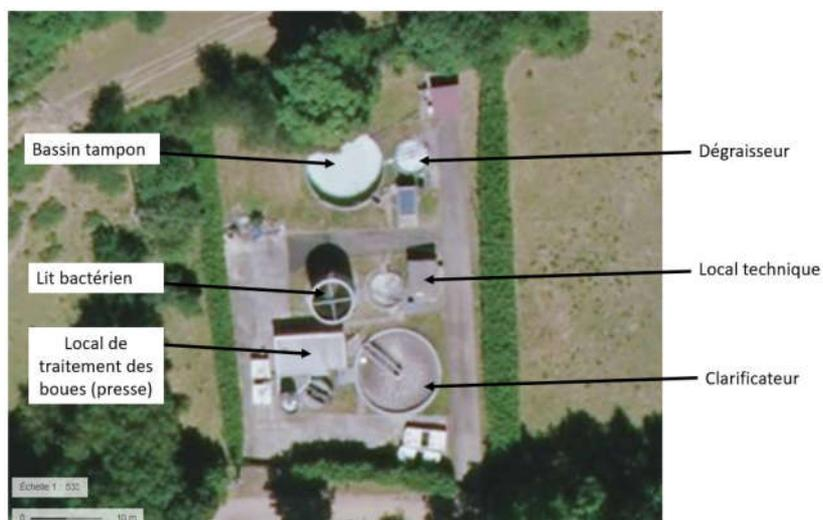
La vue aérienne permet de visualiser les implantations des bâtiments de production et de la station de prétraitement biologique.
