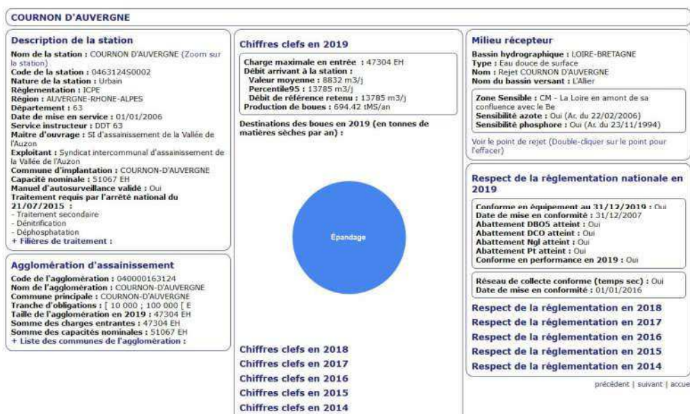
Figure 4.3 : Informations sur la station d'épuration de Cournon d'Auvergne
