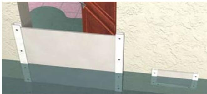
La stabilité des murs en maçonnerie de qualité courante peut être menacée dès lors que la différence de hauteur d'eau entre l'intérieur et l'extérieur atteint un mètre. Ceci conduit à limiter la hauteur des batardeaux à un mètre.
