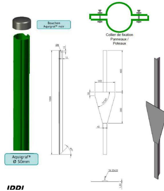
Figure 17 : Plan des poteaux de la clôture
