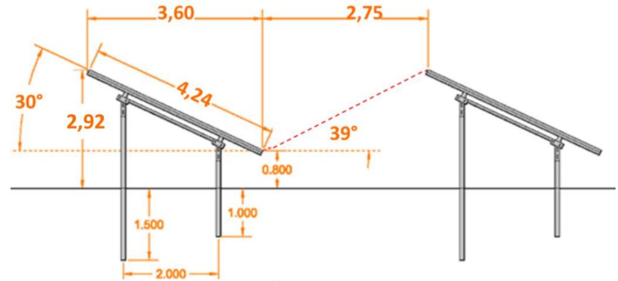
Figure 14 : Plan des structures solaires
