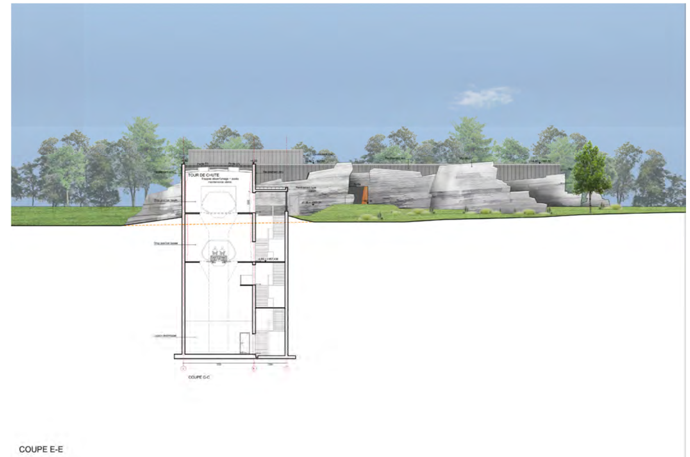
Figure 8 : Schéma d'illustration du surcreusement de la chambre de chute par rapport au terrain naturel
