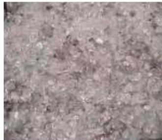
Figure 22 : Fragments de silicium et granules de verre (Source : PV CYCLE, photovoltaïque.info)
