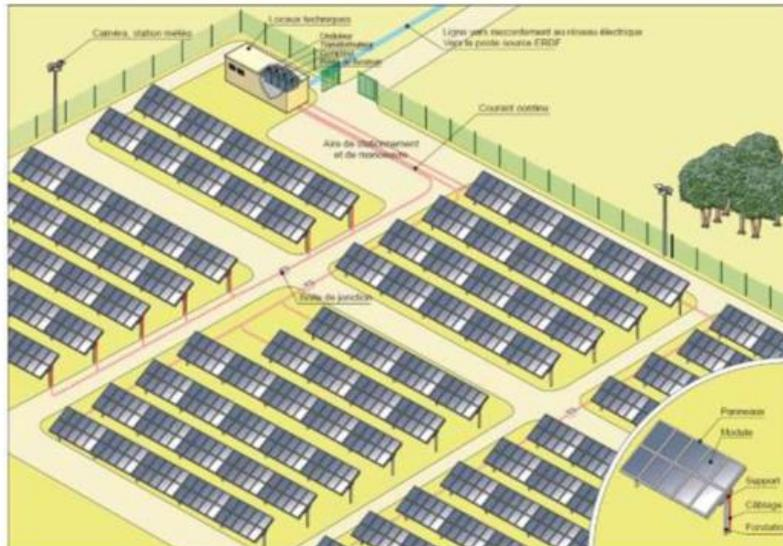
Figure 14 : Schéma de principe d'une installation photovoltaïque
