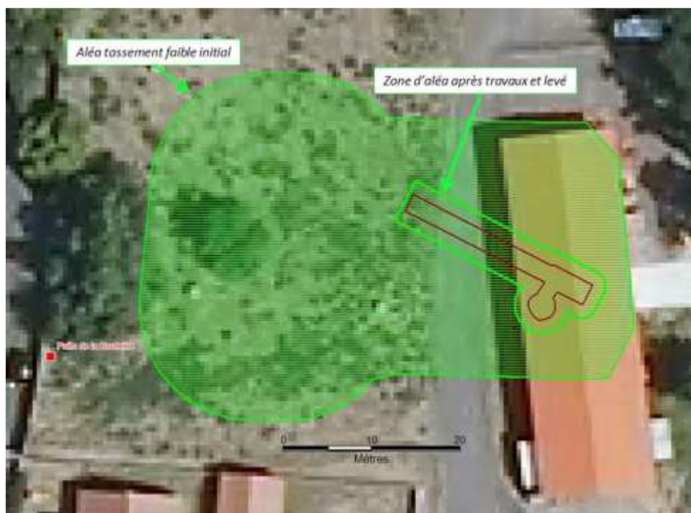
Figure 20 : Modification de l'aléa tassement
