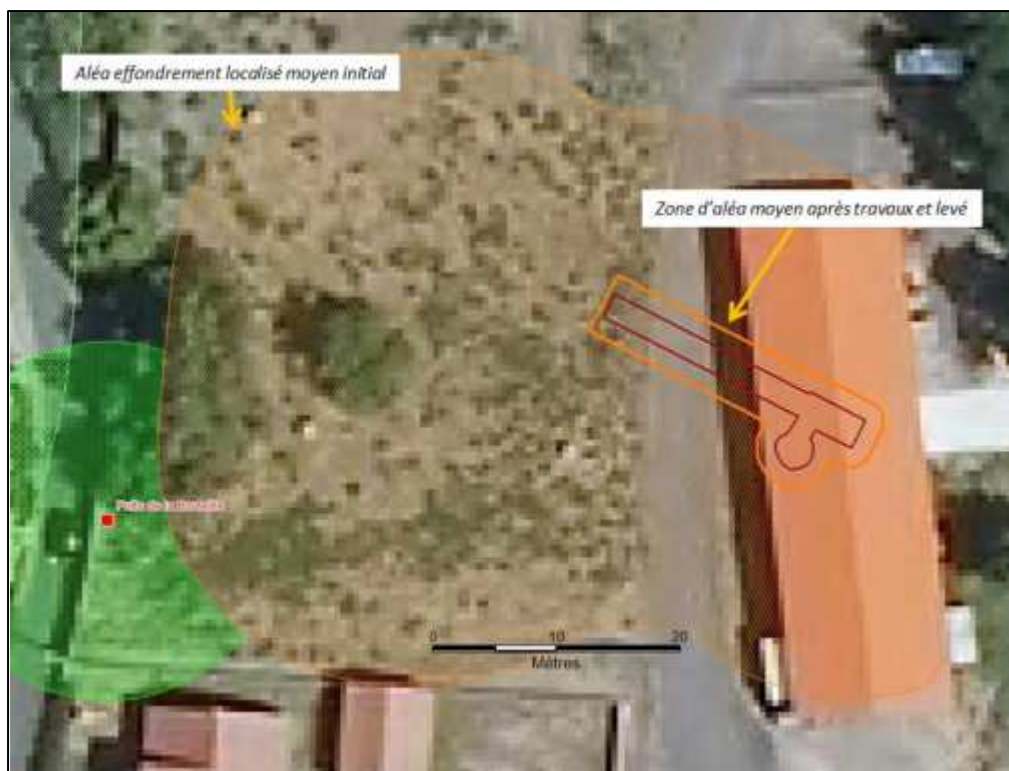
Figure 19 : Modification de l'aléa effondrement localisé moyen lié à la poudrière
