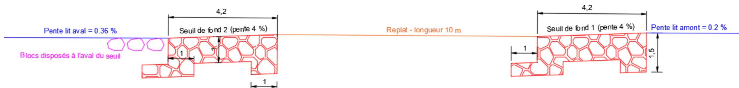
Figure : Profil en long détaillé des seuils de fond (rampe à enrochements libres)
