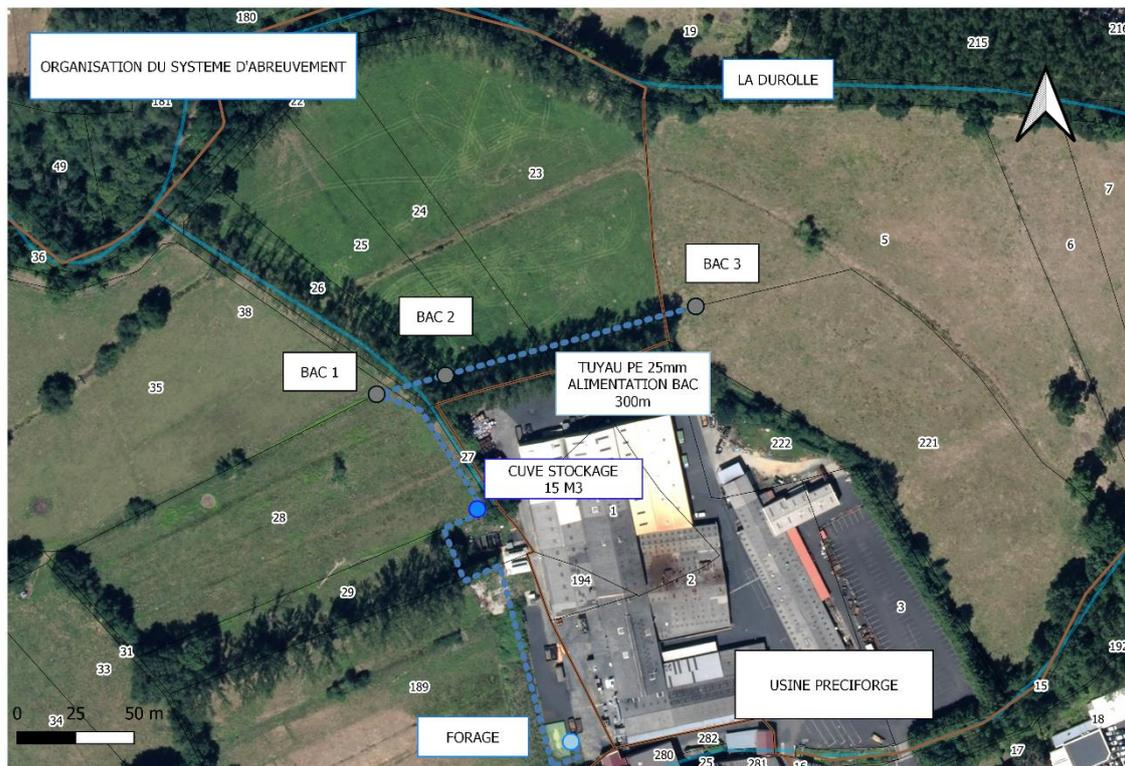
Vue en plan du dispositif d'abreuvement
