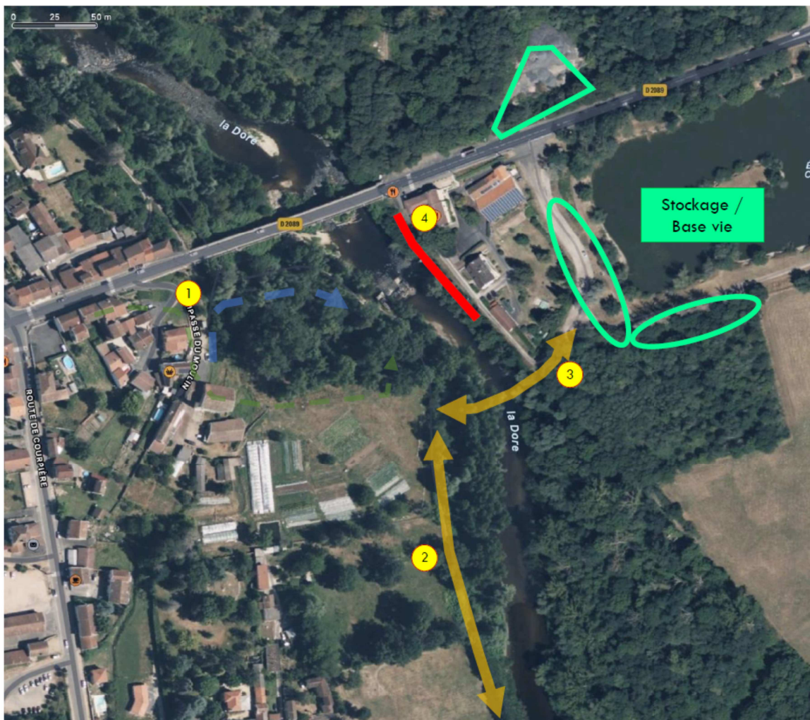
Figure 19 : Accès chantier, base de vie et site de stockage (source : CESAME 2022)
